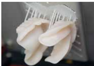
Gedruckte monolithische Einprobekörper
