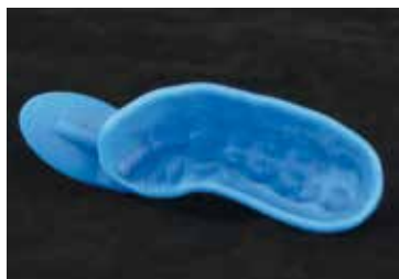
Teillöffel in hohen Schichtstärken gedruckt
