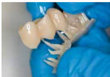
Einfaches Entfernen der Supportstrukturen
