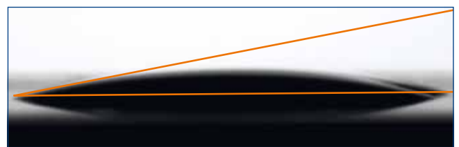
V-Posil Light Fast / V-Posil X-Light Fast / V-Posil Mono Fast – niedriger Kontaktwinkel von < 10^\circ
