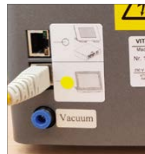
Brenngerät / Anschlusskabel (gelber Punkt + Ring)
