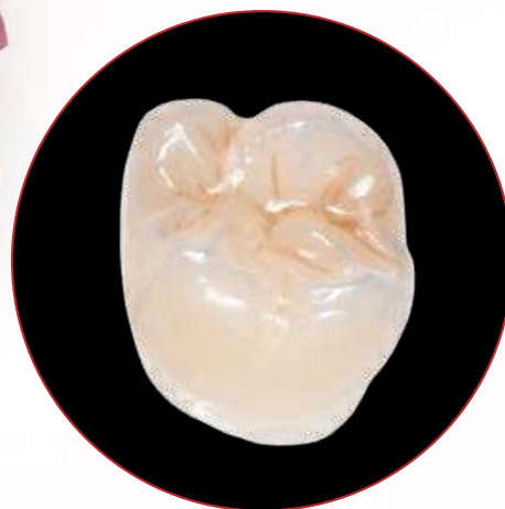
Bemalte Krone nach Verschleißtest
