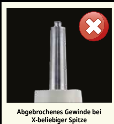
Abgenutztes Gewinde bei x-beliebiger Spitze
