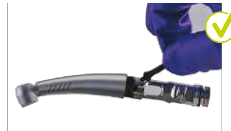
Wechsel eines Wasserfilters
