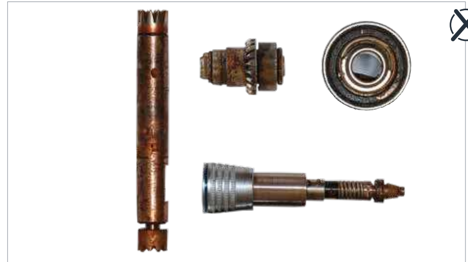
Pièces à main mal entretenues
