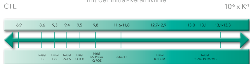
Kompatibilität der Lustre Pastes Familie und Spectrum Stains mit der Initial-Keramiklinie
