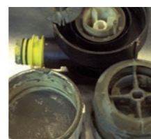
Zentrifugengehäuse, verkrustet - Totalausfall der Saugmaschine
