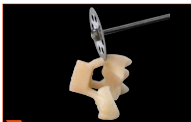
1 Presskanal mit einer dünnen Diamantrennscheibe abtrennen.
