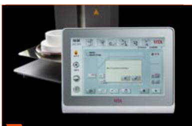
2 Après ouverture du four, le message « Placer le matériau de pressée » s'affiche.
