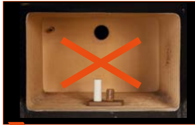
! Le piston de pressée à usage unique et les lingotins ne doivent pas être préchauffés.
