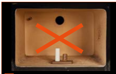
! I pistoni monouso ed i pellet non devono essere preriscaldati.
