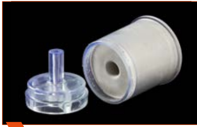
1 Retirar la base de la mufla mediante un movimiento giratorio.
