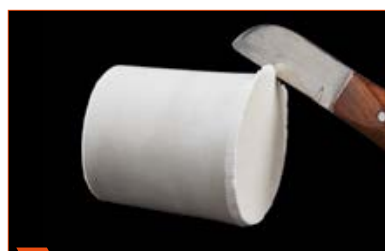
3 Rompere gli spigoli del cilindro, senza che massa di rivestimento cada nel canale.
