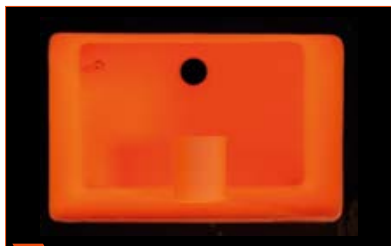
4 Posizionare il cilindro nel forno con l'apertura verso il basso. Evitare qualsiasi contatto con le pareti del forno.
