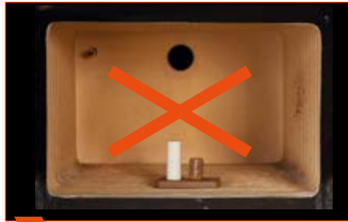
! Einweg-Pressstempel und Pellets dürfen nicht vorgewärmt werden.
