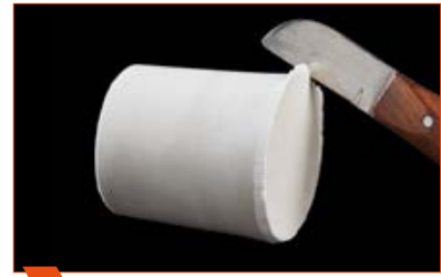
3 Enlever les arêtes du cylindre sans que du revêtement ne pénètre dans la tige.
