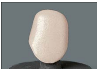
L'opaque après cuisson avec une surface légèrement brillante sur un support en céramique.
