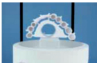
Správné umístění na sintrovací misce
