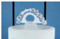
Positionnement correct sur le support de frittage
